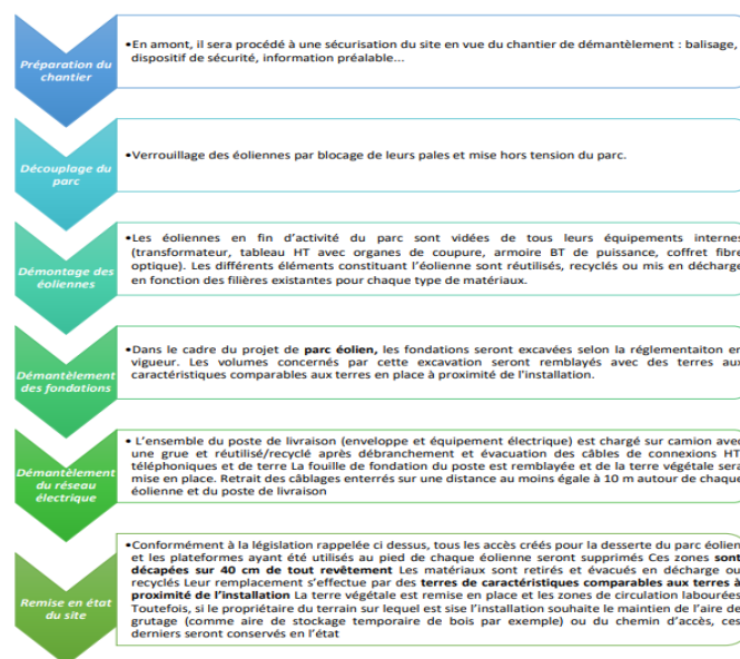
Schéma du protocole de démantèlement d'un parc éolien
